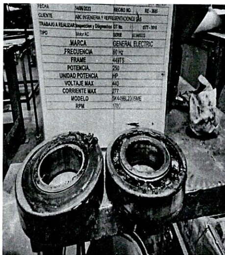
Registró 2. Rodamientos defectuosos 6314 /C3 (2).
