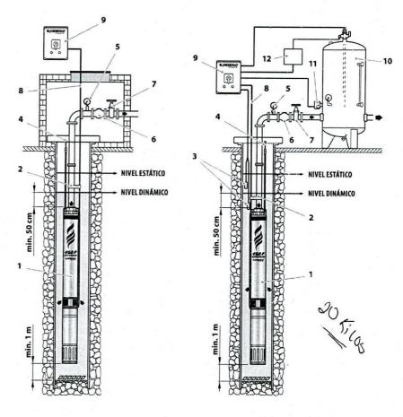
La instalación de las electrobombas 45R es apta para pozos con un diámetro no inferior a 4" (100 mm). La electrobomba sumergida se baja al pozo mediante el tubo de impulsión hasta una profundidad tal que garantice su total inmersión (min, 50 cm y por lo menos 1 metro desde el fonde del nozo) incluse mientras funciona, suando se aprecia una disminución del líquida en el pozo Cuando la elec-
