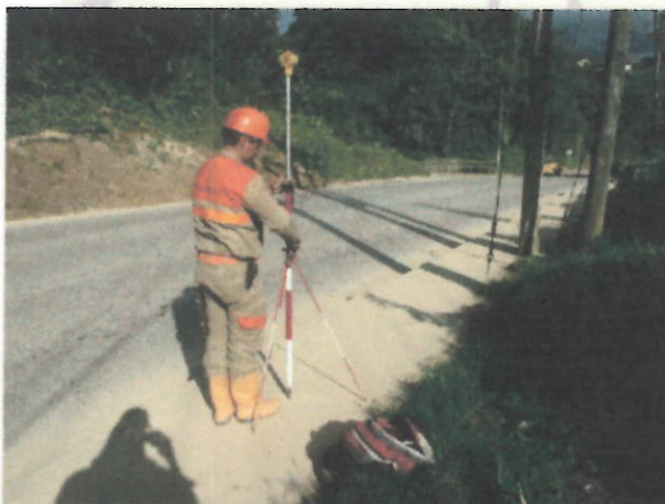
Ejemplo de la ubicación del porta-prisma en un Delta.
