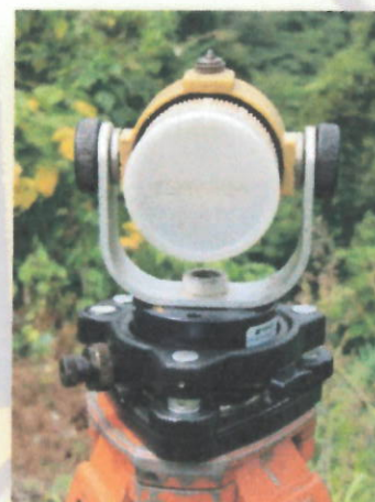
Ubicación del prisma sobre base nivelante.
