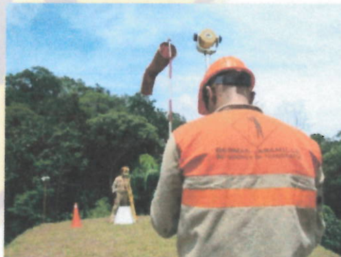
Ejemplo de una radiación.
