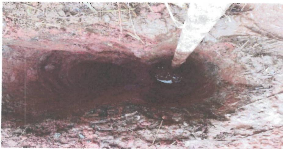
El método de exploración utilizado fue el de perforaciones con ayuda de un barreno con motor, obteniéndose muestras inalteradas con ayuda de tubos Shelby cuya longitud de hinca es de 25 cm., además de muestras de material alterado extraído con barreno. De los sondeos realizados, la perforación # 6 presento NAF a una profundidad de 4 metros medidos desde superficie.
