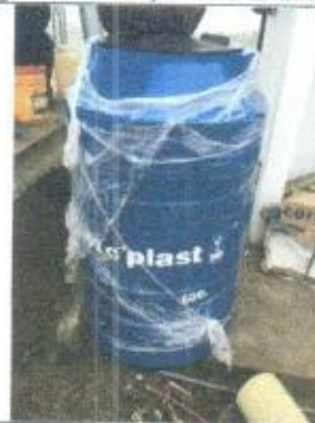
Tanques para preparación de soluciones
