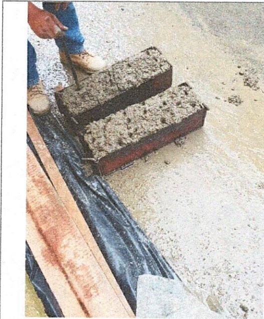
FOTO 17. Toma de viguetas
