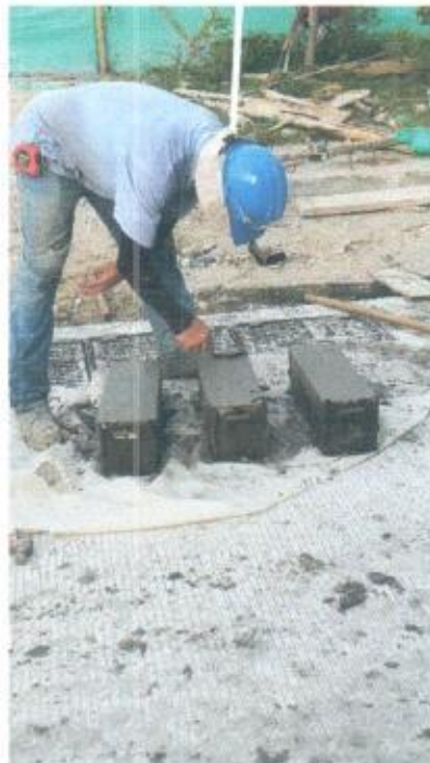
Foto 19 y 20. Toma de Viguetas para Ensayo de resistencia
