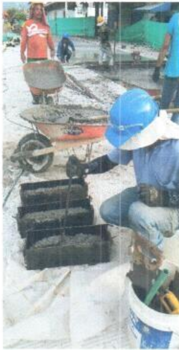
Foto 19 y 20. Toma de Viguetas para Ensayo de resistencia
