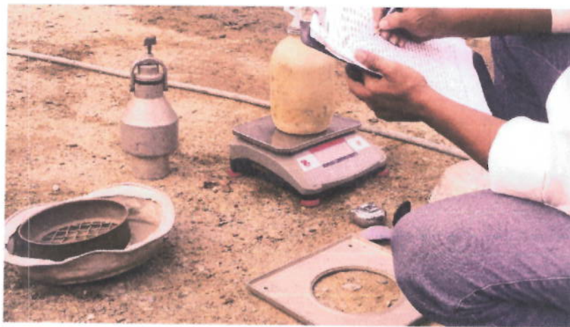
Foto 20 y 21. Toma de densidades a la sub-base y afirmado
