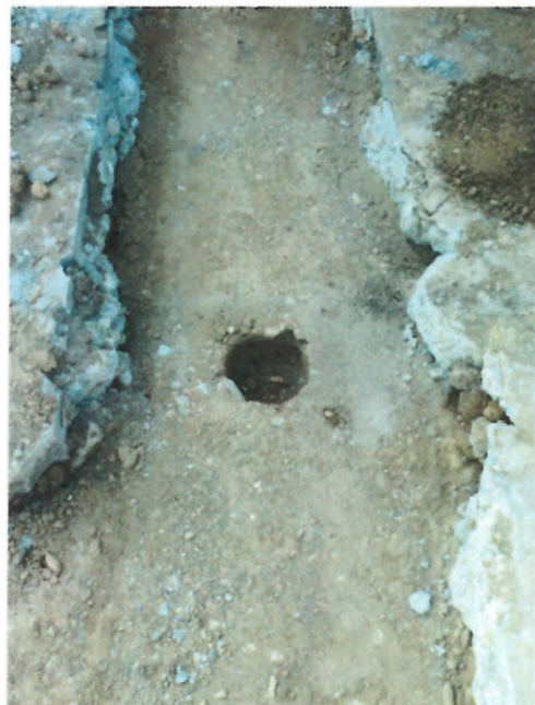
Foto 16 y 17. Ensayos de compactación en sub base.
