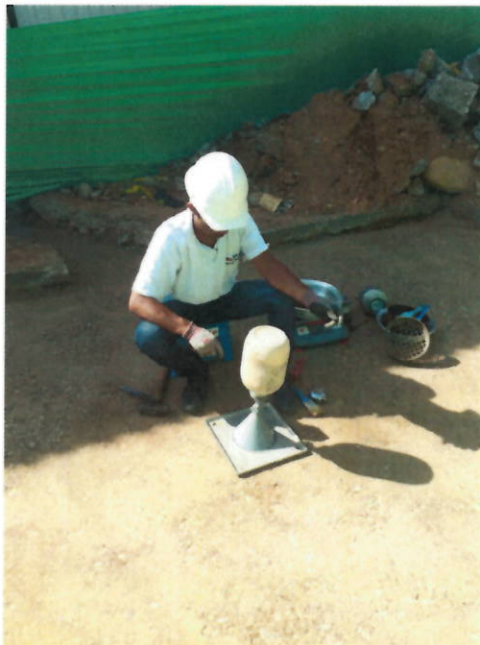
Foto 16 y 17. Ensayos de compactación en sub base.
