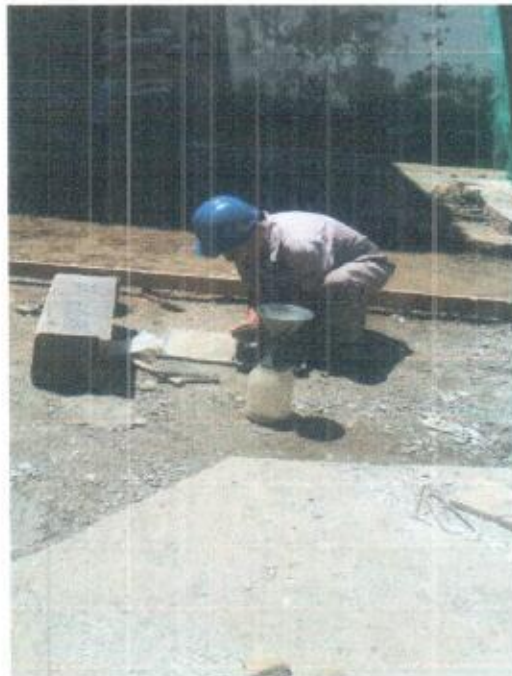
ENSAYOS DE DENSIDAD
