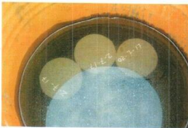
Control y curado de cilindros para verificar calidad y corrección de emposamientos
