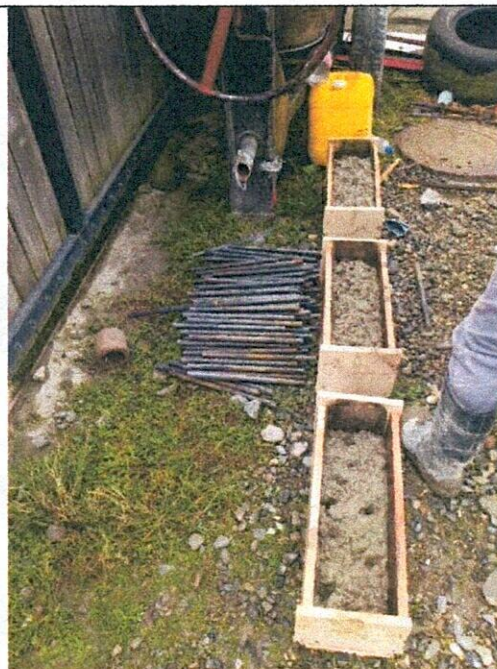
FOTO 32. Viguetas para ensayos
