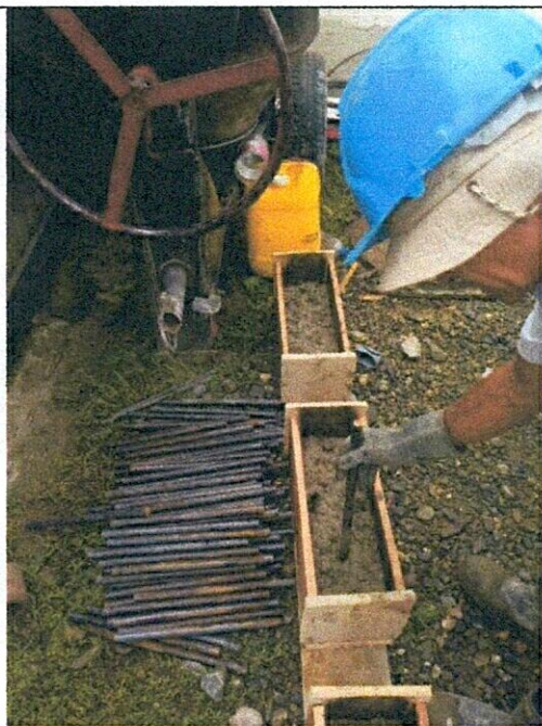
FOTO 31. Viguetas para ensayos
