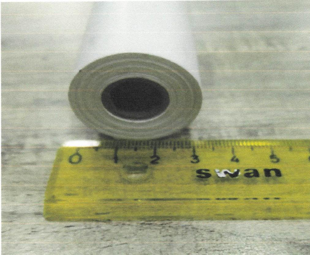
**CALIBRE DEL PAPEL:** De conformidad a la información plasmada en la ficha técnica de la impresora, se requiere un grosor del papel de 0.06 - 0.08 mm:
