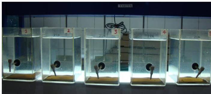
**Descripción:** La jarra 1 corresponden a agua no tratada, las jarras 2 y 3 corresponden a agua dosificada con cal al 2% con 4 y 5 ml de la solución respectivamente. Por último las jarras 4 y 5 contienen ácido sulfúrico con 0,5 y 1 ml. Se observo que las mejores condiciones de tratabilidad las obtuvo el agua tratada con pH bajo, pero igual sigue la tendencia que la Cal favorece el proceso de floculación.
