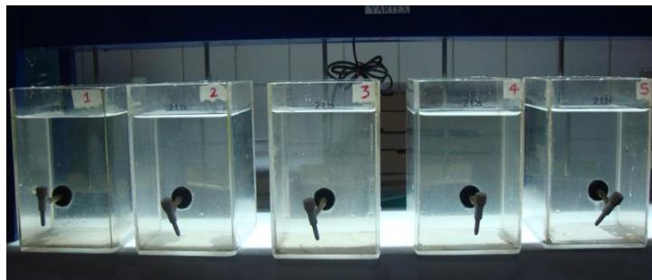
**Descripción:** La jarra 1 corresponden a agua no tratada, las jarras 2 y 3 corresponden a agua dosificada con cal al 2% con 5 y 7 ml de la solución respectivamente. Por último las jarras 4 y 5 contienen ácido sulfúrico con 0,5 y 1 ml. Se observo que las mejores condiciones de tratabilidad las obtuvo el agua sin ser tratada.
