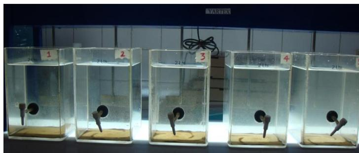
**Descripción:** La jarra 1 corresponden a agua no tratada, las jarras 2 y 3 corresponden a agua dosificada con cal al 2% con 3 y 4 ml de la solución respectivamente. Por último las jarras 3 y 4 contienen ácido sulfúrico con 0,5 y 1 ml. *Se observo que durante el proceso con floculación el agua con CAL formo floc más rápido y consistente.*
