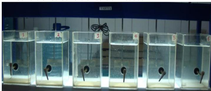
**Descripción:** La jarra 1 corresponden a agua no tratada, las jarras 2, 3 y 4 corresponden a agua dosificada con cal al 2% con 2, 3 y 4 ml de la solución respectivamente. Por último las jarras 5 y 6 contienen ácido sulfúrico con 0,5 y 0,9 ml.
