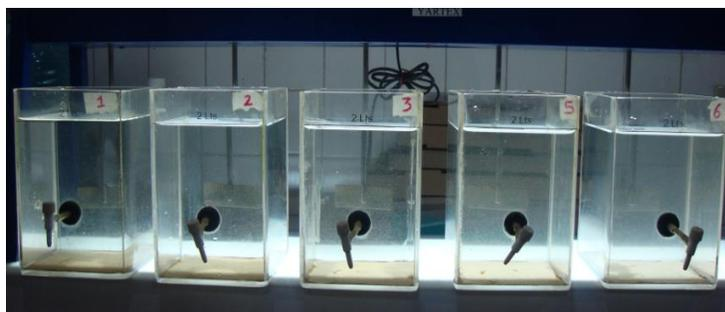
**Descripción:** La jarra 1 corresponden a agua no tratada, las jarras 2 y 3 corresponden a agua dosificada con cal al 2% con 3 y 5 ml de la solución respectivamente. Por último las jarras 5 y 6 contienen ácido sulfúrico con 0,5 y 1 ml. *Se observo que durante el proceso con floculación el agua con CAL formo floc más rápido y consistente.*
