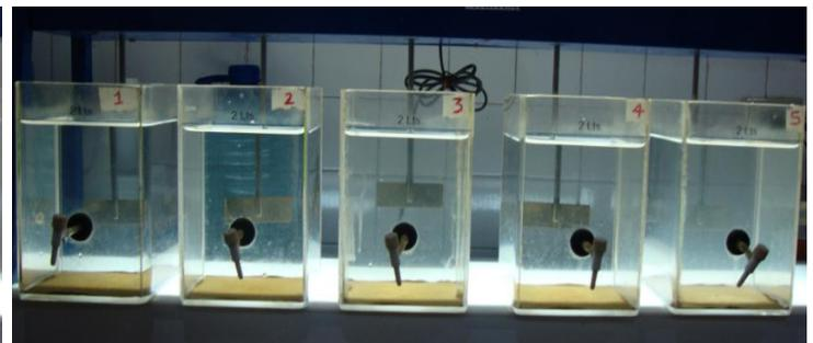
**Descripción:** La jarra 1 corresponden a agua no tratada, las jarras 2 y 3 corresponden a agua dosificada con cal al 2% con 3 y 1 ml de la solución respectivamente. Por último las jarras 4 y 5 contienen ácido sulfúrico con 0,5 y 1 ml. Se observo que las mejores condiciones de tratabilidad las obtuvo el agua tratada con Cal.
