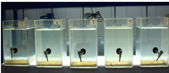
**Descripción:** La jarra 1 corresponden a agua no tratada, las jarras 2 y 3 corresponden a agua dosificada con cal al 2% con 2 y 1 ml de la solución respectivamente. Por último las jarras 4 y 6 contienen ácido sulfúrico con 0,5 y 1 ml. Se observo que las mejores condiciones de tratabilidad las obtuvo el agua sin ser tratada.
