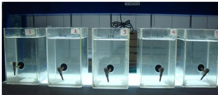
**Descripción:** La jarra 1 corresponden a agua no tratada, las jarras 2 y 3 corresponden a agua dosificada con cal al 2% con 3 y 4 ml de la solución respectivamente. Por último las jarras 4 y 5 contienen ácido sulfúrico con 0,5 y 1 ml. Se observo que las mejores condiciones de tratabilidad las obtuvo el agua no tratada.
