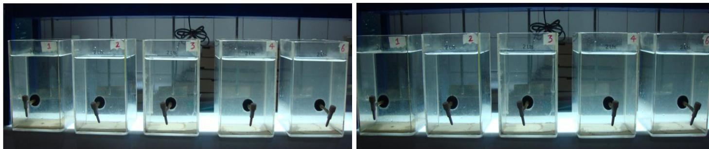
**Descripción:** La jarra 1 corresponden a agua no tratada, las jarras 2 y 3 corresponden a agua dosificada con cal al 2% con 3 y 4 ml de la solución respectivamente. Por último las jarras 4 y 6 contienen ácido sulfúrico con 0,5 y 1 ml. Se observe que las mejores condiciones de tratabilidad las obtuvo el agua tratada con Cal, aunque no hay mucha diferencia entre agua tratada y sin tratar.
