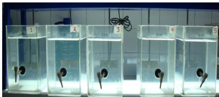
**Descripción:** La jarra 1 corresponden a agua no tratada, las jarras 2 y 3 corresponden a agua dosificada con cal al 2% con 3 y 4 ml de la solución respectivamente. Por último las jarras 4 y 5 contienen ácido sulfúrico con 0,5 y 1 ml. Se observo que las mejores condiciones de tratabilidad las obtuvo el agua sin ser tratada.
