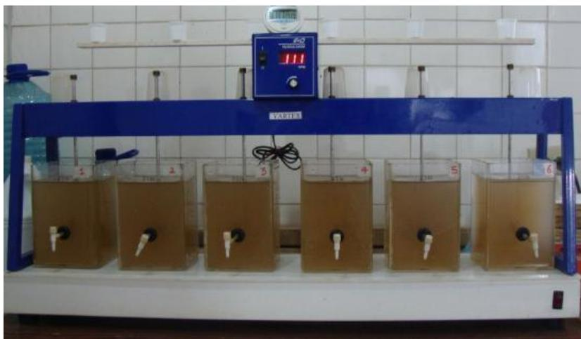
**Figura 2.** Agua Clarificada en la determinación de Dosis Optima. Se puede observar que la jarra 3 posee las mejores características y corresponde a la dosis óptima.
