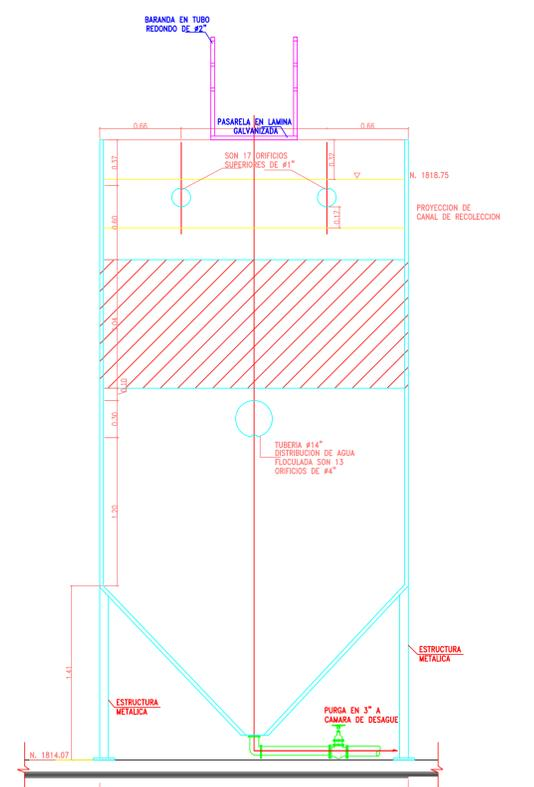
SEDIMENTADOR CORTE F-F'
