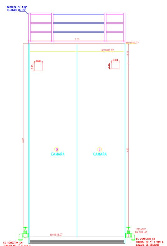
SEDIMENTADOR CORTE C-C'
