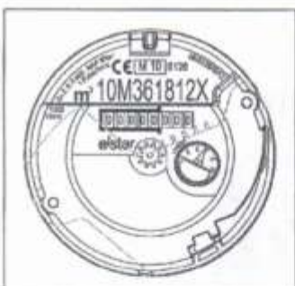
Figura 45 Contorno de la posición de un sensor inductivo en el protector de registro con cápsula de cobre MSII
