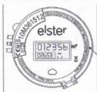
Figura 17 Marcas en el protector del V200 y V210 del registro electrónico con salida de radio
