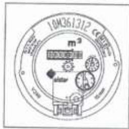
Figura 16 Disco de V200 y V210 con posición del sensor con interruptor de lengüeta
