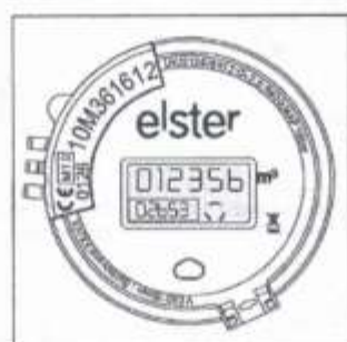
Figura 18 Marcas en el protector del V200 y V210 del registro electrónico con salida codificada
