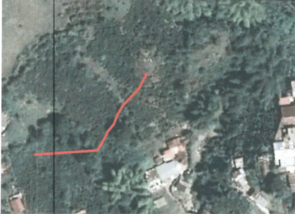
Foto N°13 Esquema aproximado de la instalación de la tubería de PVC de 8" en los predios intervenidos
