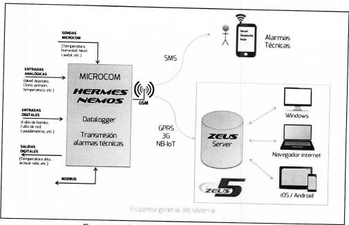
Esquema de Funcionamiento del Zeus Web
